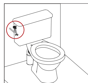
A. Débranchez l'arrivée d'eau du réservoir.
