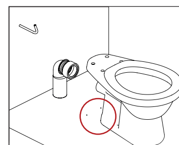
E. Retirez la cuvette délicatement de l'évacuation, là aussi vous pouvez trouver du mastic.
